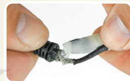
c) Dây điện bị sờn
