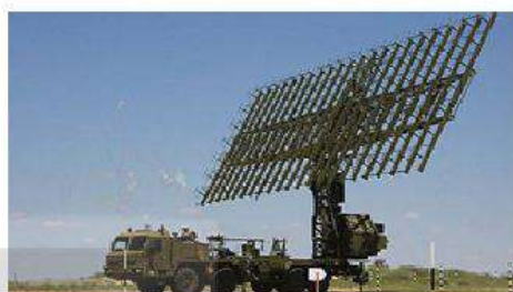
Hình 3.4. Tổ hợp radar cơ động Sopka của Nga sản xuất năm 2014, giúp phát hiện các mục tiêu khi động lực học và đạn đạo ở độ cao trung bình và độ cao lớn
