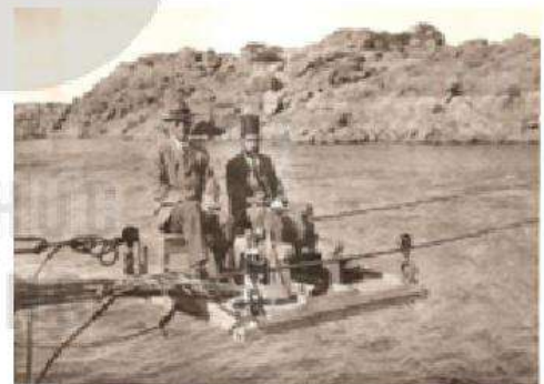
Hình 3.17. Edward Wade thực hiện các phép đo dòng chảy ở sông Nile tại Aswan, Ai Cập vào đầu những năm 1920
