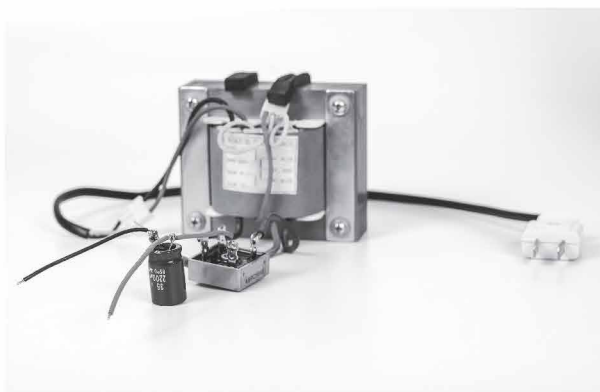
Hình 4.3. Mạch chỉnh lưu hai nửa chu kì sử dụng cầu chỉnh lưu
