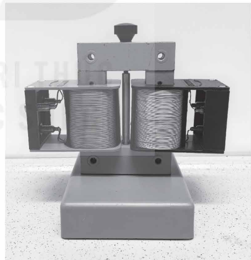
Hình 3.3. Máy biến áp thông thường
