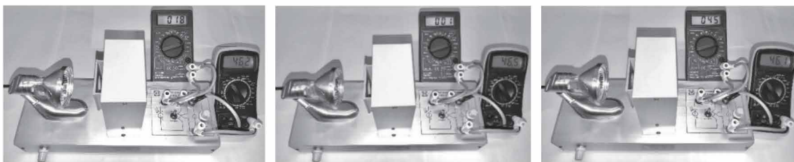
Hình 9.1. Thí nghiệm khảo sát định luật giới hạn quang điện
