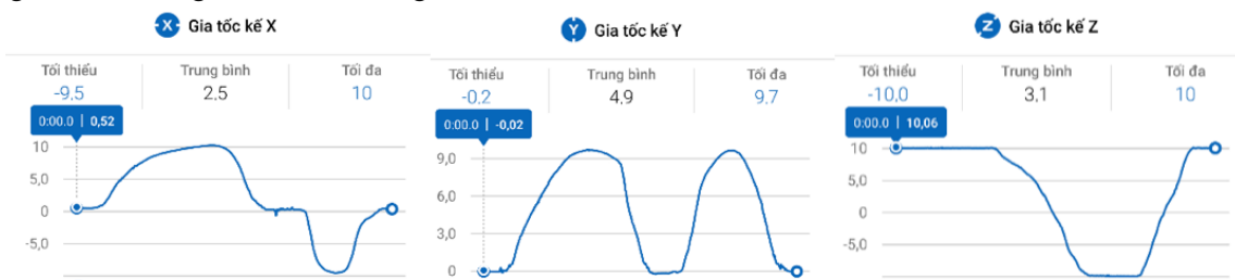
Hình 4. Kết quả thí nghiệm đo gia tốc trọng trường bằng ứng dụng Science Journal
